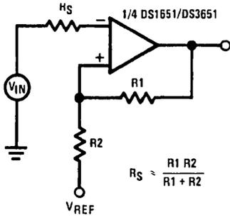
$$R_S \approx \frac{R_1 R_2}{R_1 + R_2}$$
